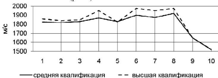
Рис.3. Средние значения скорости прохождения ультразвука по костям нижней конечности на 10 уровнях (рис.1) в зависимости от квалификации спортсмена
